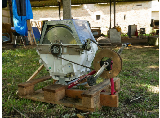
Exemple concret de Low-Tech : une machine à laver à pédales ! (source : Low Tech Lab)
